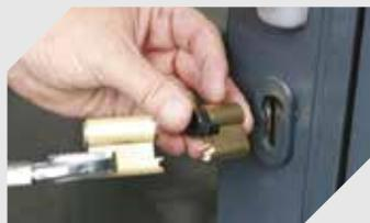
... el cuerpo del cilindro se parte por el centro, facilitando el acceso del atacante.
