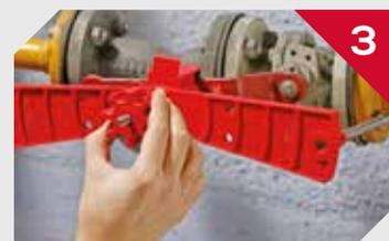
3 Tournez l'axe autour de la vis jusqu'au blocage complet puis verrouillez avec un ou deux cadenas.
