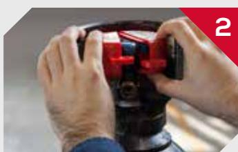
2 Placer le dispositif de verrouillage sur la clé d'arrêt de la vanne,
