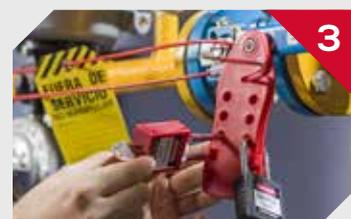
3 Verrouiller le porte-cadenas avec un ou plusieurs cadenas de verrouillage et de signalisation.
