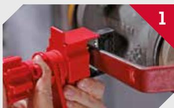
1 Appuyez sur l'axe pour ouvrir la plaque dentelée et placez le dans la poignée de la vanne.
