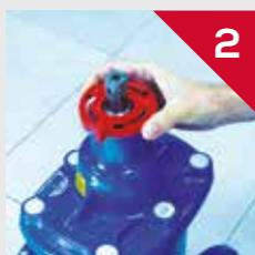
2 Placer la base du dispositif de verrouillage sur la vanne.
