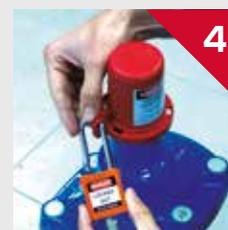
4 Couvrir la base du blocage avec le capuchon de l'appareil et alignez les trous latéraux pour verrouiller l'appareil avec un cadenas.
