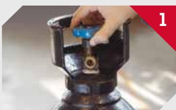
1 Fermer la clé d'arrêt de la bouteille de gaz.
