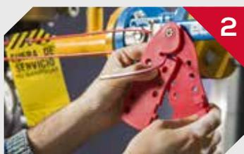
2 Insérer le câble à travers la fente la plus proche de l'axe d'ouverture du porte-cadenas. (Il est conseillé de signaler la zone en faisant passer une étiquette à travers le câble avant de l'introduire dans le porte-cadenas).
