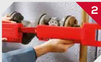
2 Introduire le bloc court à travers le bord de la poignée et le long à travers son coude. Aligner les orifices des blocs.
